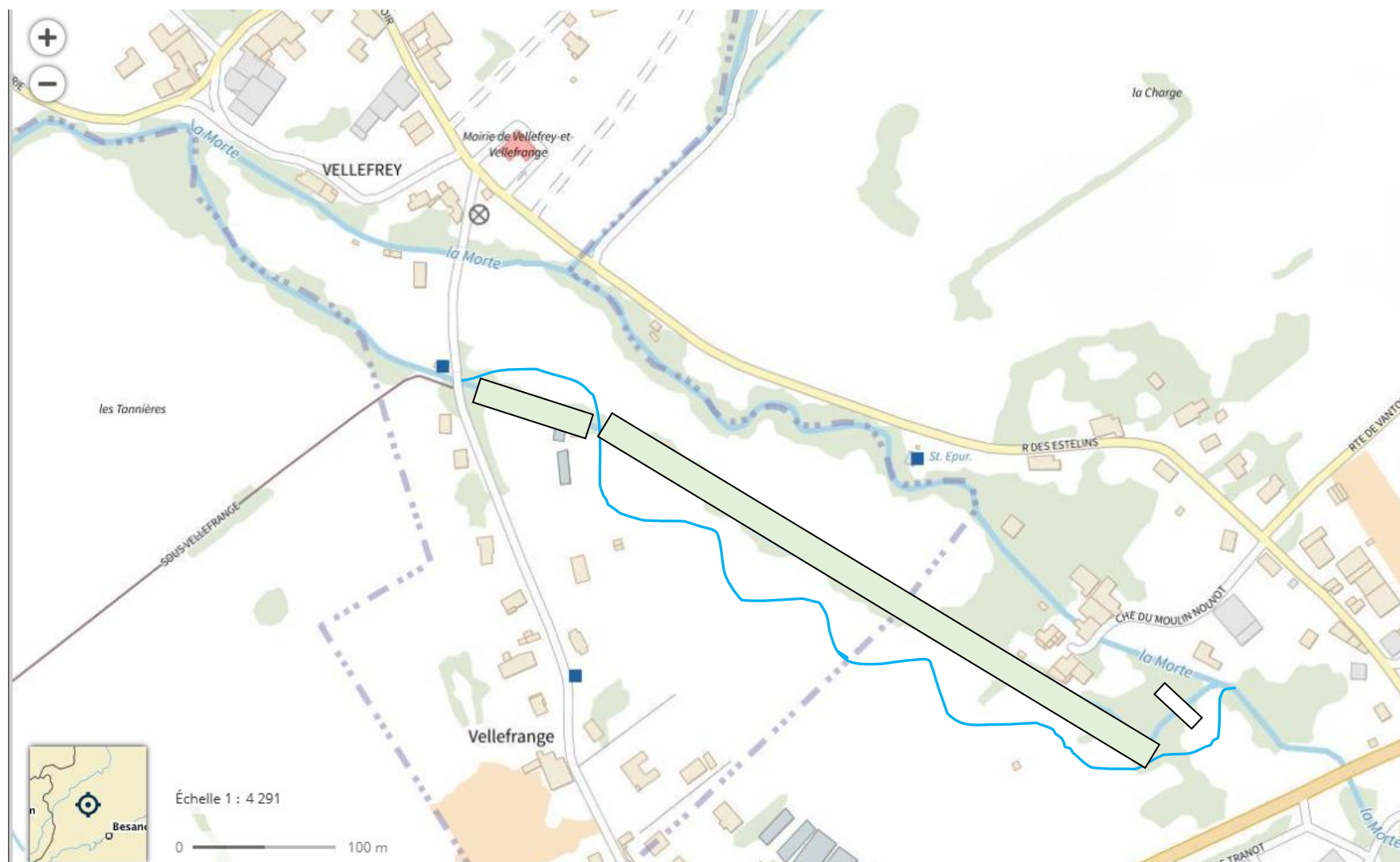
Figure 53 : barrage Raby et Poulnot. Conservation des 2 bras existants. Variante
